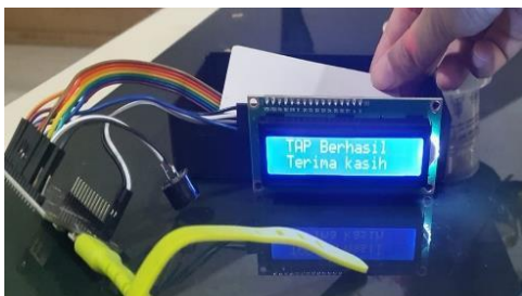
Gambar 37. LCD Menampilkan Info Tapping Berhasil Sumber Data : Hasil Olahan Data Penelitian
