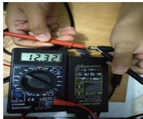
Gambar 3.1 Pengukuran Tegangan Output Adaptor
