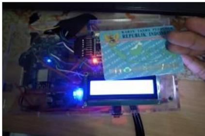
Gambar 4.4 Proses Pengujian Data E-KTP dengan *Output* Berupa LCD 16x2
